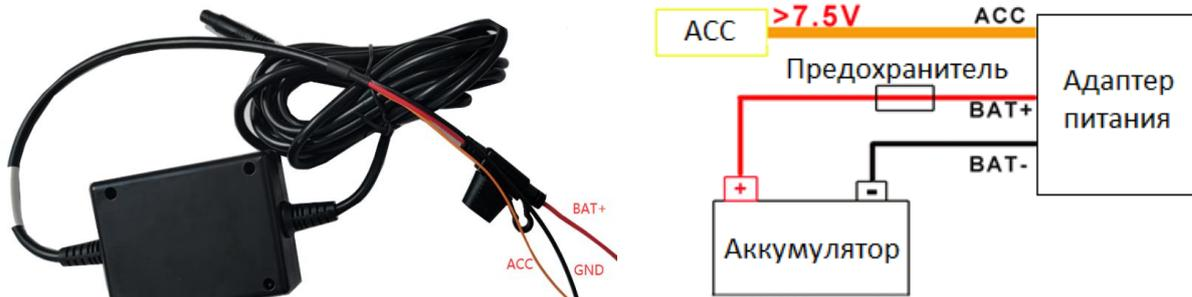
*Примечание: при тестировании устройства, подключите оба провода – красный и оранжевый к положительному полюсу источника питания, в противном случае устройство не включится.*
