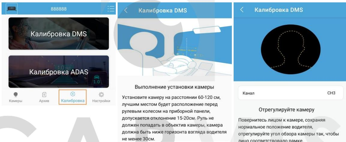
Система DSM поддерживает такие функции как: распознавание курения, разговор по телефону, смыкание глаз, зевание, отвлечение при вождении, отсутствие водителя, использование солнцезащитных очков и прикрывание камеры. Любую из этих тревог можно отключить или перенастроить.
