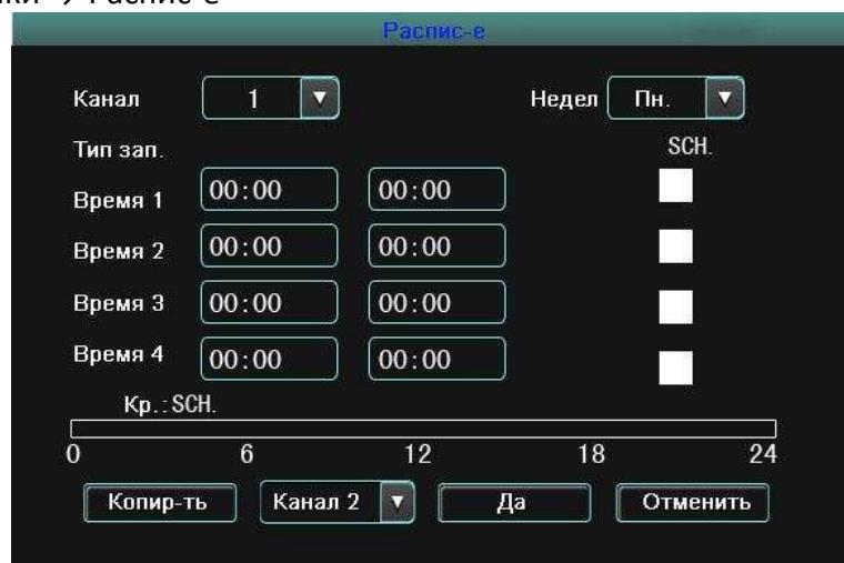
В данном окне выбираются промежутки времени для записи видео, а также записи обнаруженного движения и при срабатывании сигнализации.
