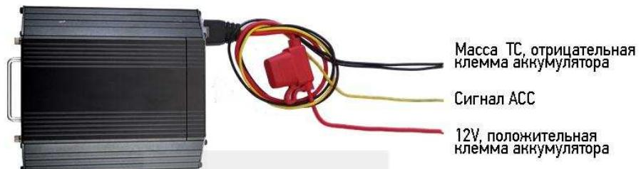
*Примечание: при тестировании устройства, подключите оба провода – красный и желтый провод с положительным полюсом источника бесперебойного питания, в противном случае устройство не загрузится.*
